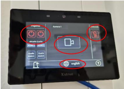
Die Sprache kann über "english" gewechselt werden. Über die Power-Symbole werden die beiden Beamer an- und ausgeschaltet und über das Kamera-Symbol die Kamera.
